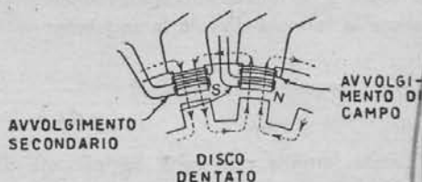
Fig. 2.12. - PRINCIPIO DEGLI ALTERNATORI AD ALTA FREQUENZA.
