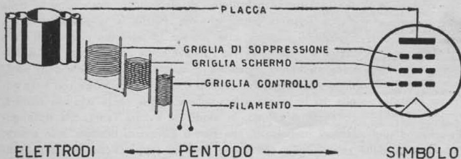
Fig. 3.12 A. - ELETTRODI E SIMBOLO DEL PENTODO. I segnali da amplificare giungono alla prima griglia, detta griglia controllo, o griglia 1. Le altre due griglie, poste tra di essa e la placca, servono solo per impedire la retrocessione dei segnali già amplificati, e in tal modo consentono elevate amplificazioni.
